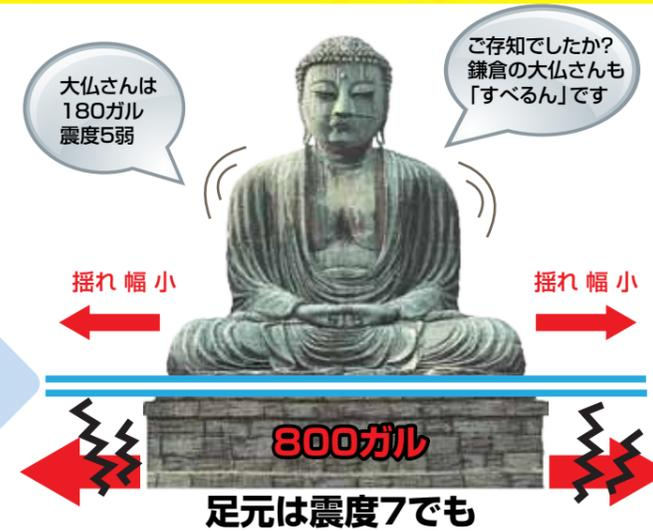
鎌倉の大仏(高德院)は、関東大地震や翌年の余震による損傷の修復が大正14年に行われましたが、昭和35年(1960年)～翌36年には台座と仏像の間にステンレス板を敷く構造(免震構造)に改修されました。[メモ:鎌倉震災誌]
