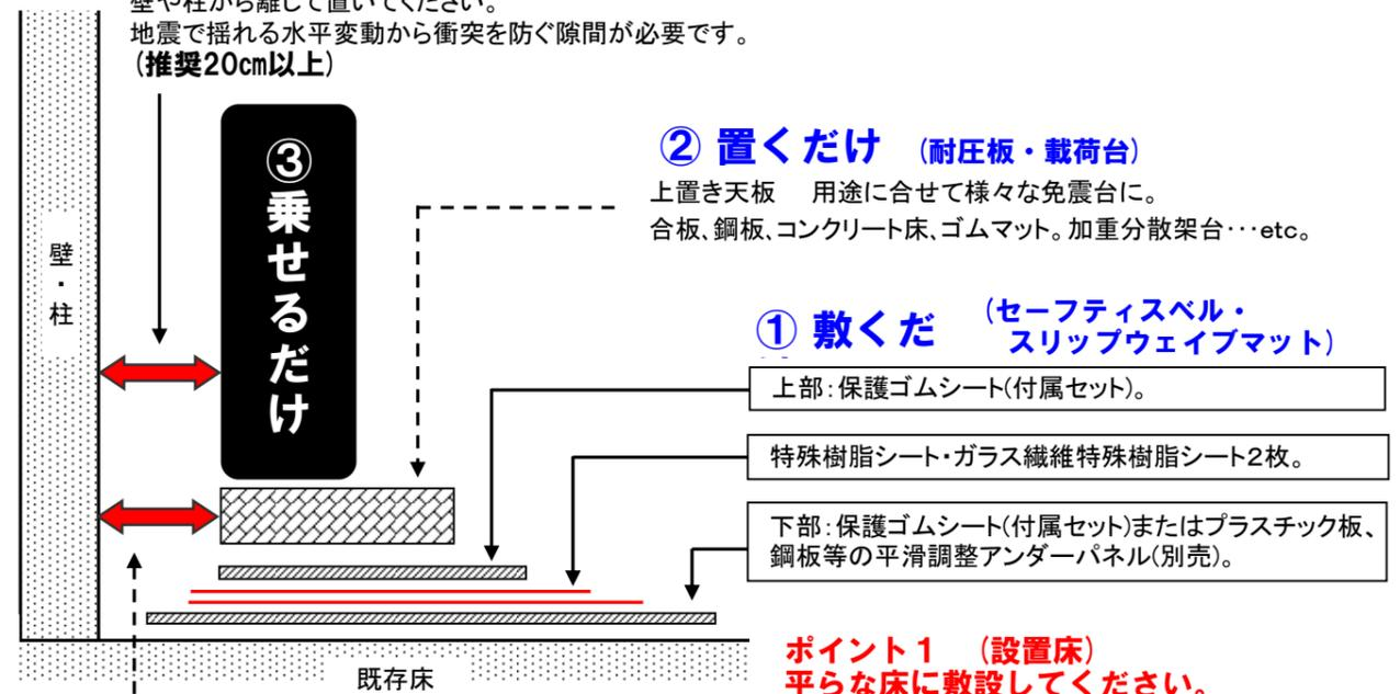
地震で揺れる水平変動量は、振動特性によって異なります(裏面【地震の揺れ幅と免震床のスリップクリアランス】参照)。震源地での長周期地震振動の揺れ幅は1mを超える可能性もありますが、東日本大震災および阪神淡路大震災の観測最大値を現実的スペースから考慮した20cm以上(〜40cm)の水平変動を吸収する隙間「スリップクリアランス」を推奨しています。
